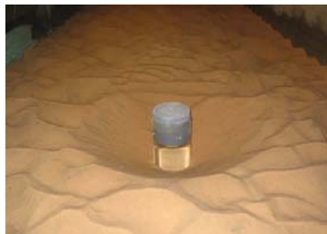
Figuur 24 Bodemerosie rondom een circulaire stapel in het laboratorium.
